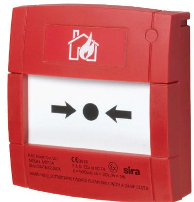
Le MCP3AR000Fx-01IS est équipé d'un contact inverseur dont on sélectionne la position NO ou NF par les bornes du connecteur enfichable. Le bouton poussoir est disponible tant avec vitre à briser qu'avec vitre réarmable.
