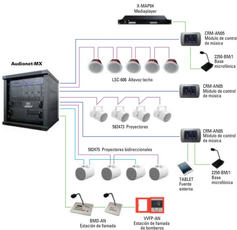
El sistema AUDIONET-MX es una solución modular que permite una gran flexibilidad. Para cada zona podrá asignarse un amplificador digital de 120 W, 240 W o 480 W optimizando así la configuración. Con una capacidad máxima de 110 líneas, pudiendo ser éstas líneas sencillas o líneas A/B.
