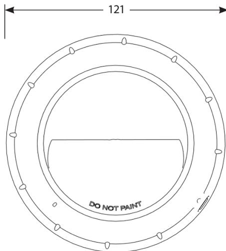
El flash de montaje en pared de NOTIFIER by Honeywell homologado EN54-23 es un dispositivo alimentado del lazo de gran calidad y diseñado para poder instalarse de forma rápida y sencilla. Se alimenta de la central de incendios a través del cableado del lazo. El funcionamiento y control del dispositivo se realiza mediante el protocolo OPAL o CLIP de Notifier. El dispositivo se instala simplemente girándolo sobre la base universal B501AP.
